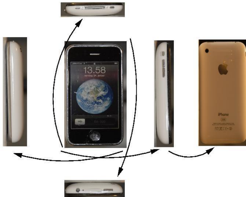
Figur 110 Relasjonene mellom de forskjellige projeksjoner. Pilene viser hvordan du vender objektet for å vise de forskjellige deler av objektet.
